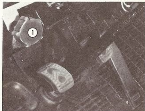
Fig. 40 - Regolazione dei proiettori durante la marcia 1 - Pomello di regolazione
