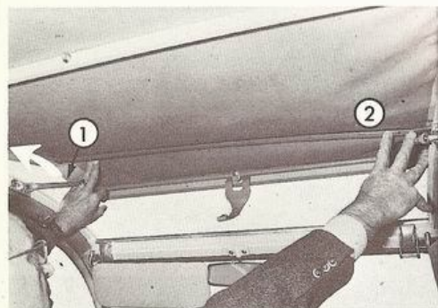
Fig. 25 - Apertura anteriore della cappotta 1 - Telaio anteriore 2 - Traversa
